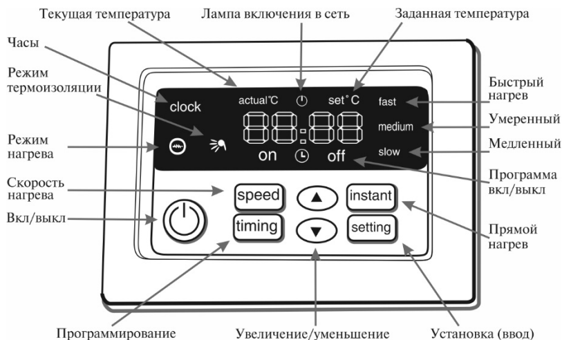
Рисунок 2. Панель блока управления и расположение функциональных кнопок
