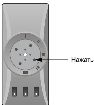
Рис. 3. Расположение штока на термовыключателе термостата.
